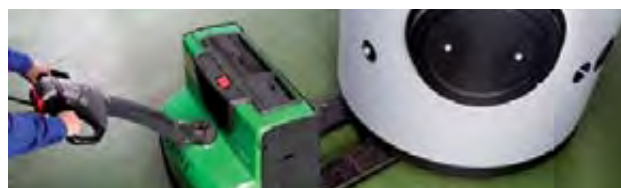
СИСТЕМА ТРАНСПОРТИРОВКИ: Проемы внизу бака упрощают погрузку/разгрузку, можно использовать автопогрузчик (от 1500 литров и более).
